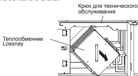
3. В моделях LGH-200RVXT-E и LGH-250RVXT-E для демонтажа теплообменников третьего блока Lossnay используйте крюк для технического обслуживания.
